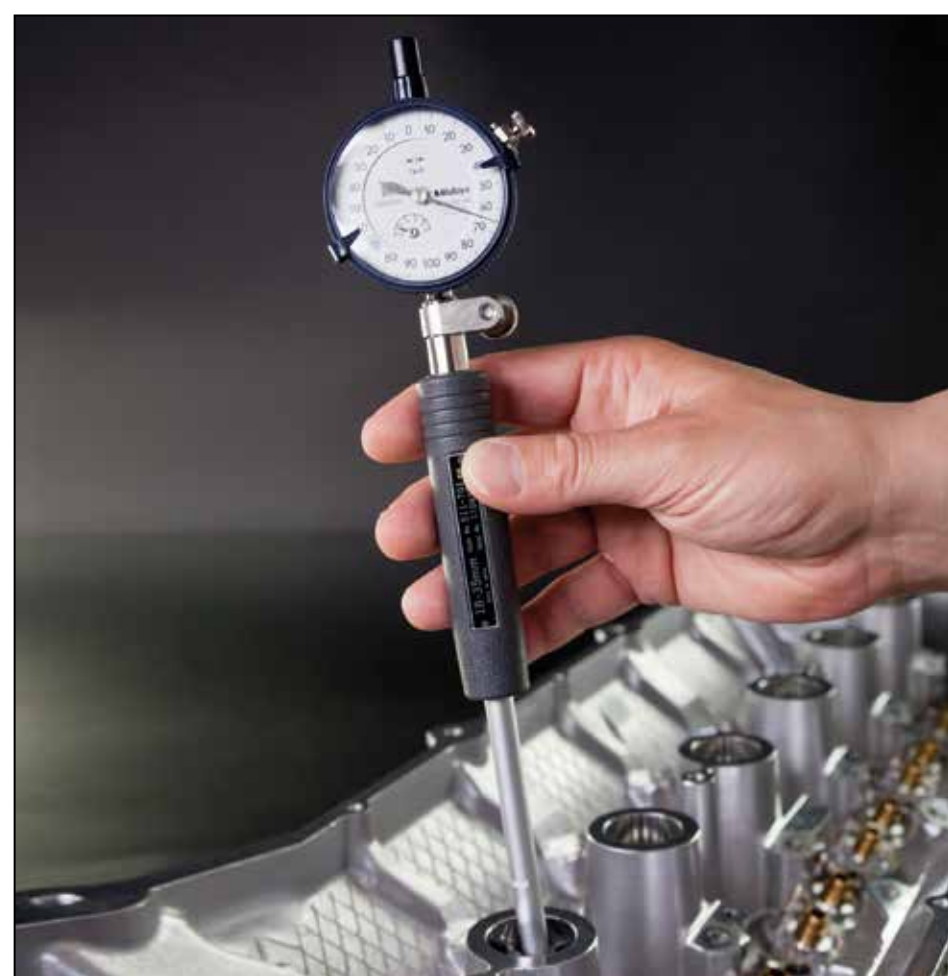
Comparatore applicato ad alesametro per la misura di diametri interni
