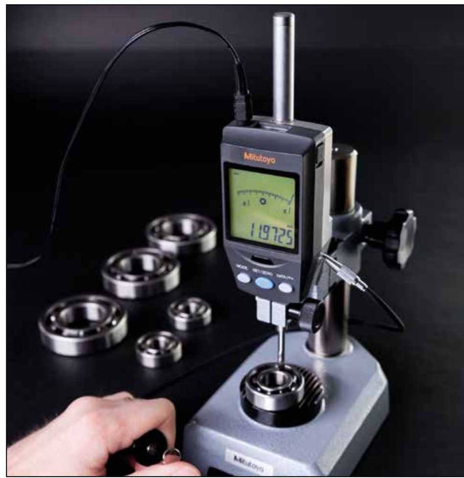
Comparatore digitale multifunzione installato su apposito stativo
