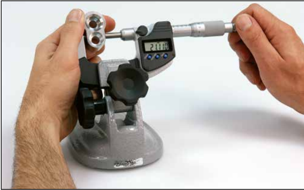
Frizione su nottolino di avanzamento rapido
