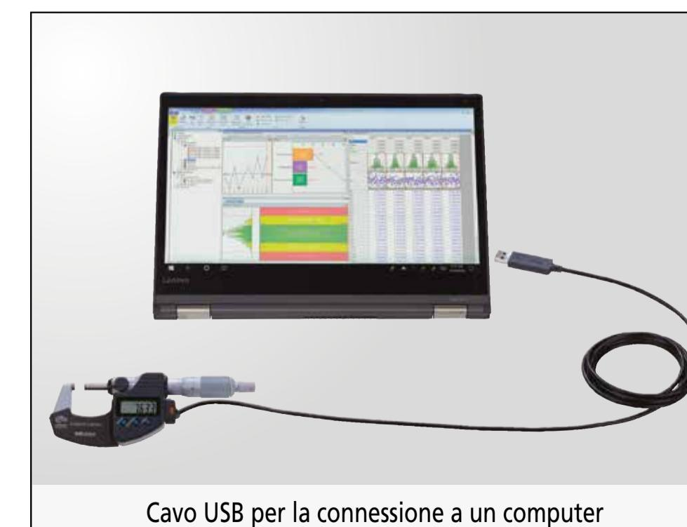
Cavo USB per la connessione a un computer
