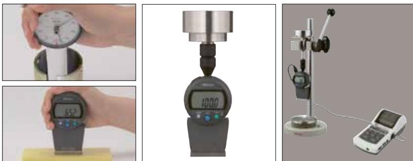
**Pezzi tipici misurati:** possono essere scelte scale diverse a seconda del materiale. Shore A per materiali morbidi e Shore D per materiali duri sono le scale usate più comunemente. Per materiali molto morbidi e la schiuma può essere usata la scala Shore E.
