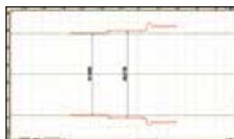
**Pezzi tipici misurati:** profili di filettature esterne e interne possono essere misurati usando un profilometro per tracciare tutto il profilo. Il sistema fornisce una lettura grafica e numerica del risultato di misura. Parti rotanti ad alta precisione, che hanno richieste molto elevate in termini di dimensioni geometriche, scanalature, angoli e distanze.
