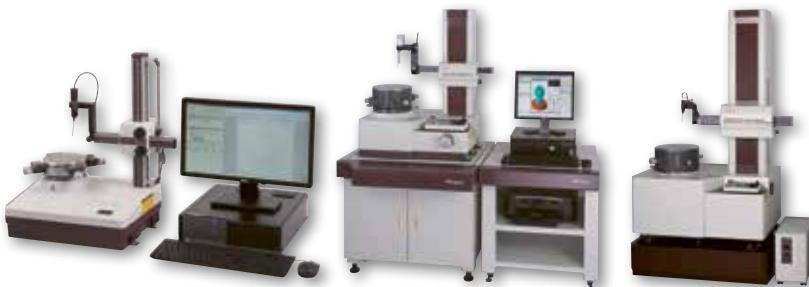
**Caratteristiche:** le caratteristiche cilindriche di un pezzo possono essere misurate con efficienza tramite rotondimetro. Questi sistemi possono misurare e analizzare la rotondità, la planarità, la concentricità, la rettilineità, la coassialità, la perpendicolarietà, la cilindricità e l'eccentricità assiale e radiale del GD&T (tolleranze geometriche e dimensionali).
