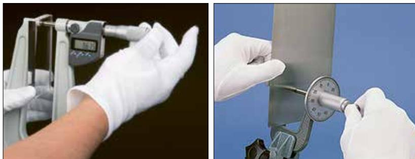
**Pezzi tipici misurati:** lamiere e pannelli di vari materiali, pezzi standard, se necessario
