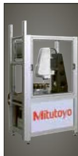
**Pezzi tipici misurati:** corse da medie a lunghe che richiedono misure 3D con volumi di produzione elevati in cicli completamente automatici
