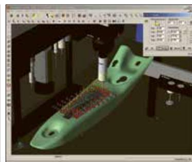
**Pezzi tipici misurati:** corse da medie a lunghe che richiedono misure 3D con accuratezza e ripetibilità standard o elevata in cicli completamente automatici.
