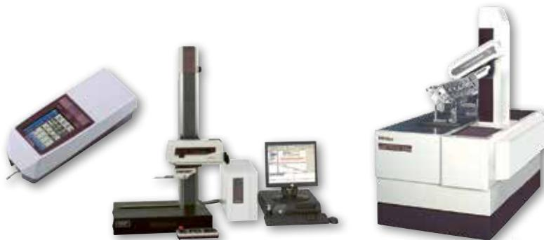
**Caratteristiche:** i rugosimetri sono usati per misurare e memorizzare il profilo superficiale tracciando la superficie con un detector altamente sensibile dotata di uno stilo diamantato. La rotondità, caratterizzata da lunghezze d'onda corte, è isolata dalle lunghezze d'onda più lunghe tramite filtri elettronici. I profili superficiali sono divisi in profilo rilevato, primario, di rugosità e di ondulazione.
