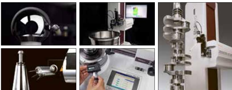
**Pezzi tipici misurati:** parti di veicoli come iniettori, pistoni, valvole del motore e altre parti con elevati requisiti relativi ai parametri GD&T per assicurare prestazioni di alta qualità. I produttori di cuscinetti sono interessati ad analisi delle armoniche e della rotondità per assicurare prestazioni a lunga durata.
