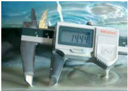
Il dispositivo deve essere posizionato in acqua nella posizione in cui viene normalmente utilizzato. Il punto più basso della scocca deve essere ad un metro di profondità. I calibri Mitutoyo IP67, dimostrano inoltre una grande resistenza allo stress, grazie all' utilizzo di nuovi sistemi di impermeabilizzazione appositamente progettati per questi strumenti.
