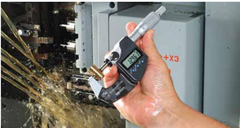
Il micrometro digitale per esterni IP 65, sviluppato da Mitutoyo, segna un passo fondamentale nel miglioramento delle classi di protezione. E' infatti il primo, nel suo genere, ad offrire un simile livello di protezione. In precedenza tutti gli altri micrometri per esterni potevano al massimo offrire una classe di protezione IP54.
