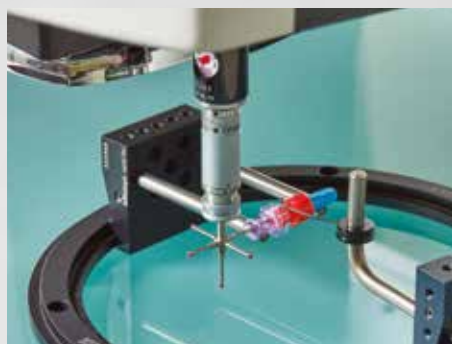
Esempio di misurazione di una valvola utilizzata in apparecchiature medicali
