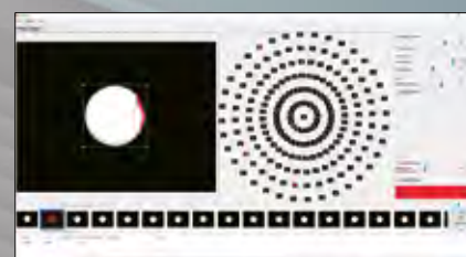
Ispezione per l'assenza di sostanze estranee nei fori del soffione doccia
