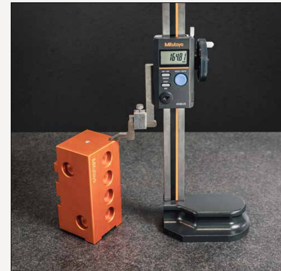
Misurazione dell'altezza con la superficie di misurazione della punta a tracciare.
