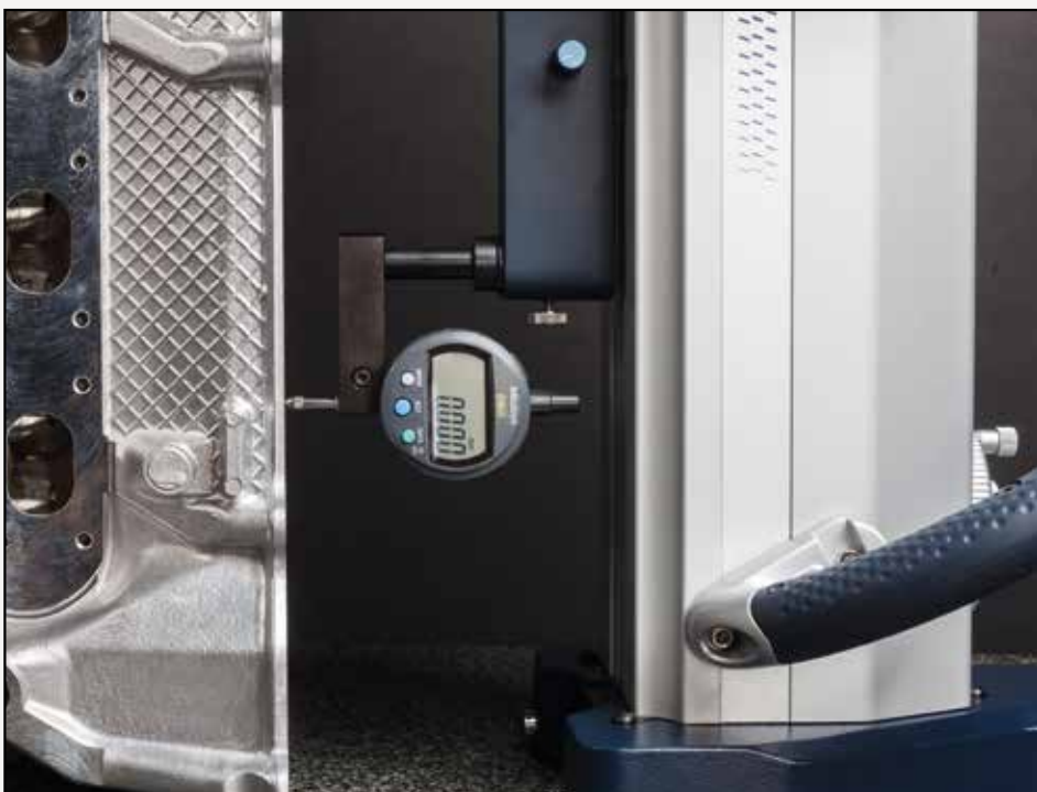
Un comparatore a leva o digitale può essere usato per misurare la rettilineità o la perpendicolarità con un truschino.
