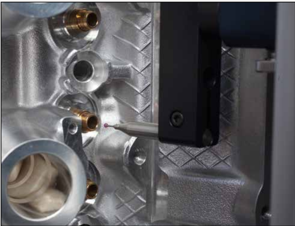
Tastatori diversi consentono al truschino di misurare molte caratteristiche diverse del pezzo.
