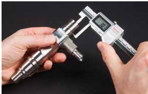
Applicazione di un calibro per cave
