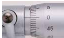
(b) Lettura diretta della linea di fede
