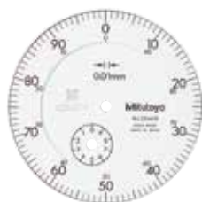
Scala progressiva (graduazione bidirezionale)
