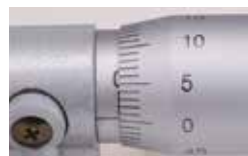
(a) Lettura della linea di fede dall'alto
