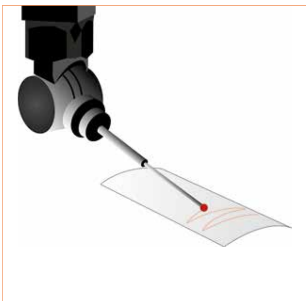
REVO 2 Scansione rapida a 5 assi da qualsiasi angolazione
